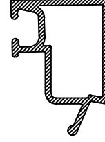
FF - 762 32mm.Cama Göre Çıta Glazing With 32mm.Gap 0,263 kg/m
